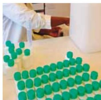
7. 溶液をすぐに最終容器（例：500 mLまたは100 mLのプラスチック製ボトル）に分け、使用前に72時間隔離保管する。これにより、アルコール中や新品／再使用したボトルに残存する細菌胞子を不活化する時間を確保できる。
