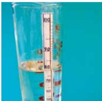
2. エタノールまたはイソプロパノール溶液を使用する場合は、製造後の分析が必須である。アルコールメーターを使用して最終使用溶液のアルコール濃度を管理する。許容範囲は、目標濃度の±5%（エタノールの場合には75～85%）に固定する。
