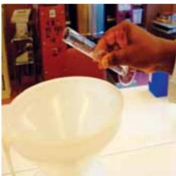
3. グリセリンも、計量用シリンダーを用いて、加える。グリセリンは粘度が高く、計量用シリンダーの内壁に付着するので、滅菌蒸留水または煮沸して冷却した水で洗い流した後、ボトル／タンクに入れること。
